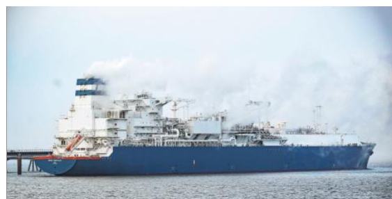
Eine schwimmende Fabrik: Dieses Schiff kann flüssiges Erdgas so umwandeln, dass es durch Rohre fließen kann. Foto: dpa
