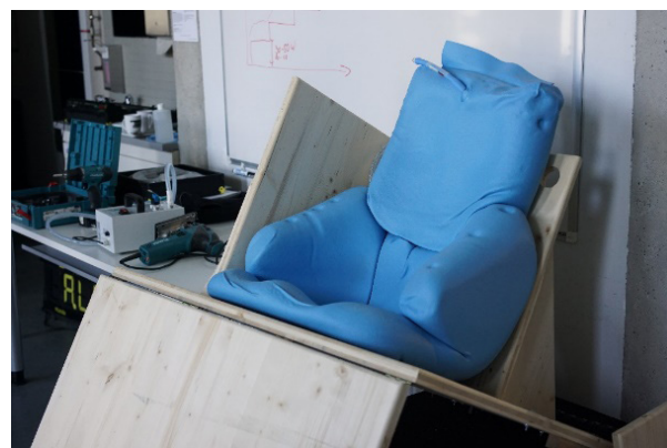
Abb.1: Versuchsstand mit Vakuum Kissen und Athlet (oben) und Abdruck nach Entfernung einer Seitenwand und Herausheben des Athleten (unten)
