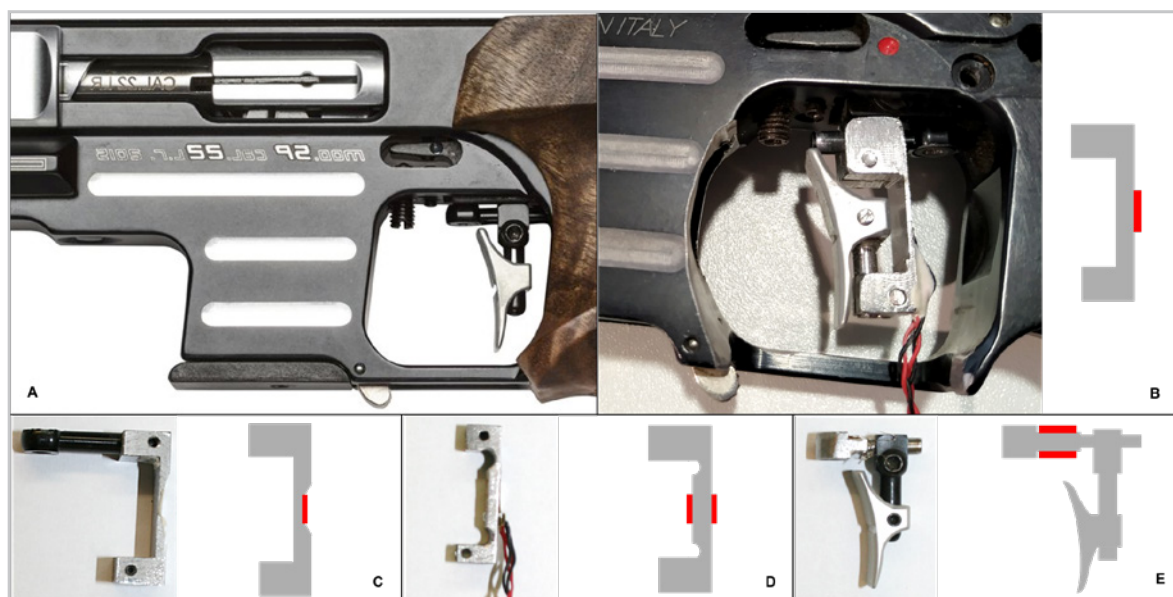
Abb. 1: Entwicklungsverlauf des instrumentierten Züngels. A: Herkömmliche Schnellfeuerpistole (Pardini); B: Erster Prototyp verbaut in Schnellfeuerpistole, Position des Dehnungsmessstreifen in Rot; C-E: Weiterentwicklung des Züngels mit abnehmender Baugröße sowie zweiseitiger DMS-Platzierung.
