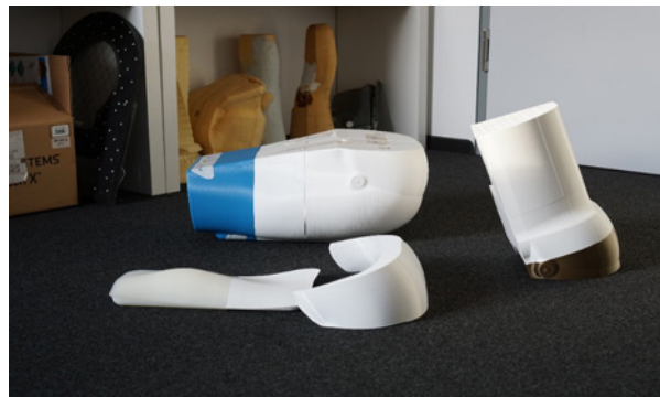
Abb. 9: Fertiges Set an Schalenwerkzeug zur Carbonanlaminierung
