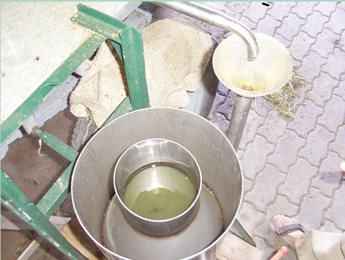
Sortie de l'huile essentielle dans le bac récupérateur
