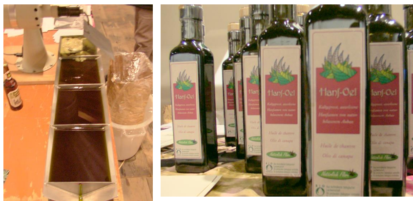
Photo de gauche : le décanteur dans son ensemble. Le premier bac capture les écumes de presse, les trois autres jouent le rôle de filtres. A la sortie, l'huile est directement consommable et conditionnable. Photo de droite : le produit fini c'est-à-dire l'huile en bouteille (produit d'un concurrent suisse allemand mais néanmoins collègue à Valchanvre)
