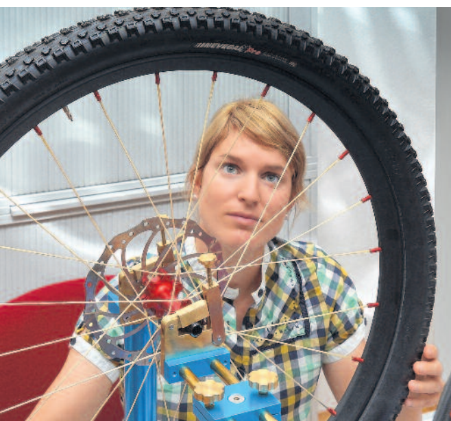
Daniela Storch vom Gründerteam PI ROPE der TU Chemnitz prüft an einem Zentrierständer den Rundlauf eines Laufrades, in das die neuartigen textilen Fahrradspeichen eingesetzt sind. Foto: TU Chemnitz/Wolfgang Thieme
