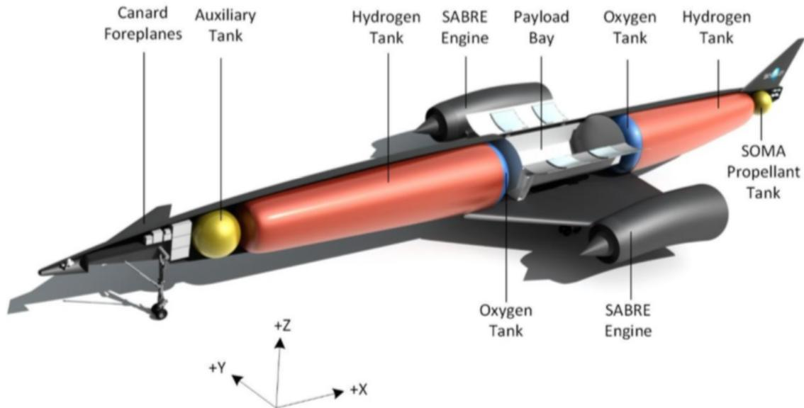
Figure 3. SKYLON internal layout.<sup>8</sup>
