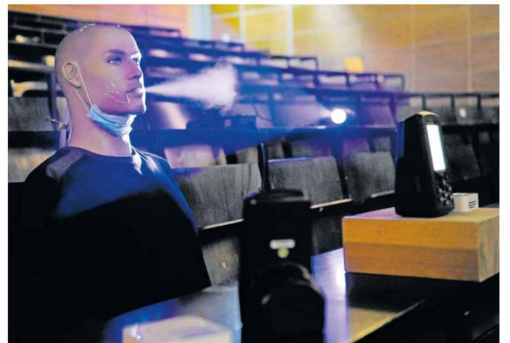
Dummy „Oleg“ in Aktion: Er simuliert durch einen Schlauch aus Mund und Nase das Ausatmen von Aerosolen und Kohlenstoffdioxid. Foto: TU Clausthal
