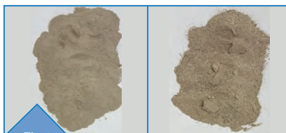
Fly ash di caldaia con iniezione di Depurcal® MG (a sx) e senza iniezione (a dx)
