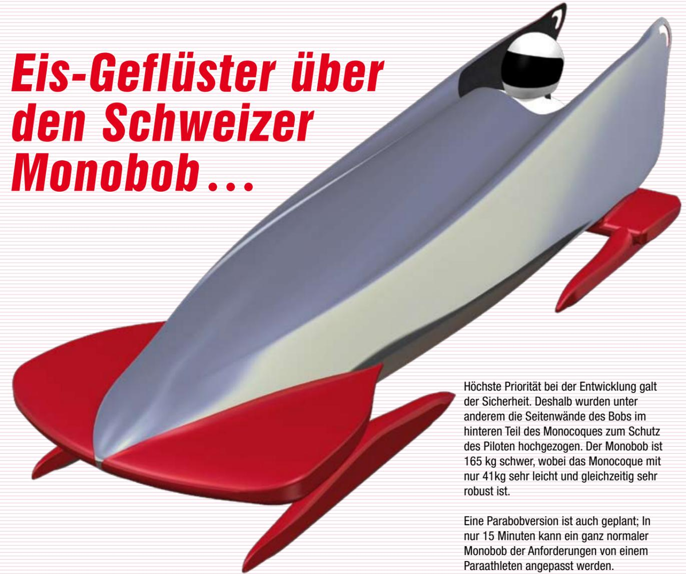
Höchste Priorität bei der Entwicklung galt der Sicherheit. Deshalb wurden unter anderem die Seitenwände des Bobs im hinteren Teil des Monocoques zum Schutz des Piloten hochgezogen. Der Monobob ist 165 kg schwer, wobei das Monocoque mit nur 41kg sehr leicht und gleichzeitig sehr robust ist.
